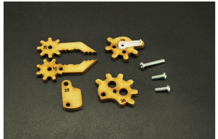
Uniremos las pinzas (#27 y #28) por encima de la pieza #24, pasando los tornillos de abajo hacia arriba, el tornillo mediano pasarlo del lado de la pieza 27. Después colocar por encima la pieza #25 y atornillar, como se muestra en la imagen:
