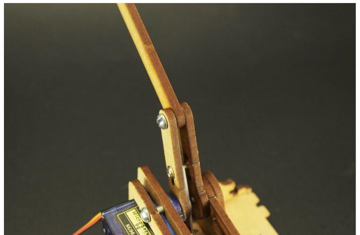
Vamos a continuar haciendo uso de la pieza #15 y las dos partes laterales del brazo robot. Primero ensamblamos la pieza #15 en el lado izquierdo de la pieza #10 con un tornillo y su tuerca. Para que quede más fijo.
