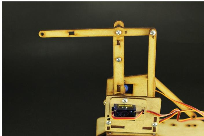
Haremos uso de las siguientes piezas: #17, #18, #19 y #20. Comenzamos ensamblando la pieza #19 con la #17 del lateral, con la rueda (#20) entre las dos, como se muestra.
